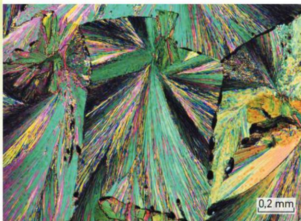
B Cristaux obtenus par refroidissement lent d'un « magma » d'éthylvanilline.
