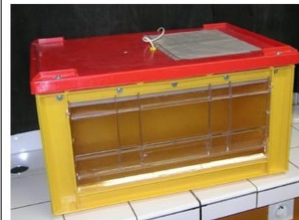
Une boîte à UV est une enceinte dans laquelle on peut soumettre les levures à des rayonnements UV. Cette boîte est protégée de façon à ce que le manipulateur ne soit pas exposé aux UV.
